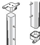
5/ 下部の取付金具とポールを付属の木ねじ(φ3.5×25)で、固定してください。天井面になる金具は、天井の高さとのクリアランスを確保する為、ビス止めをしないでください。
