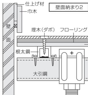
図1 ビス留付位置 詳細図(単位:mm)
