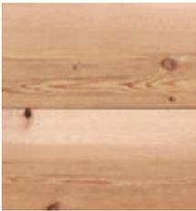
針葉樹の中で最も高いとされる寸法安定性と殺菌力を持つ成分の力で腐朽菌や害虫の侵入を防ぐレッドシダーを外壁に採用
