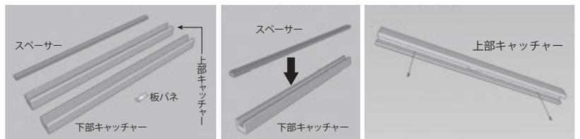
パネルキャッチャーの施工は「上下はめ込み」のため、表面に力を加えやすくとたわみが発生します。強度が必要な場合にはポールをご使用ください。
