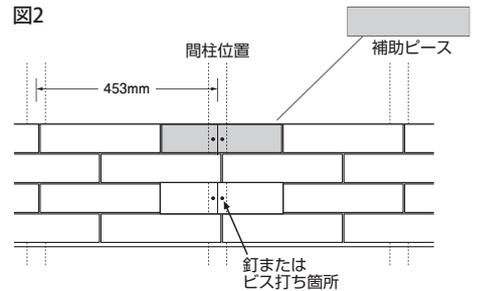
補足:レッドシダー(ハーフサイズ)も基本施工手順は同じです。ただしピース幅が半分になり、補助ピースが倍(4枚)になります。
