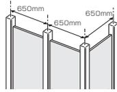
2/ 天井高さに合わせてポールを上下均等に切断してください。ポール長さは、天井高さより取付金具の厚み上下5mmずつ計10mmと、ポールを立てるクリアランス分を引いてください。
