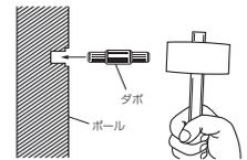
4/ ポールを垂直にして、天井裏よりクギを打って固定してください。天井と床下地に予め補強材を入れておくことと強く固定できます。
