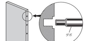
6/ 次にくるポールとパネルを一体化させた後、垂直に、立っているポールへ差し込みます。位置を確認したら、4の天井・床固定を行ってください。
